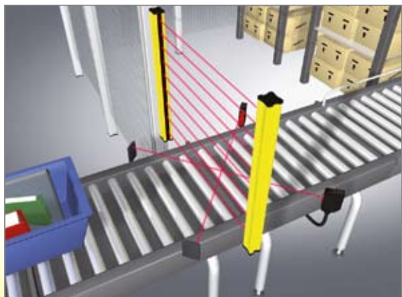
Systém blokování v automatickém skladu pro dodávky materiálu pro výrobu.
