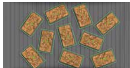
Detekce produktu: 10 ks s otočením < 200 ms
